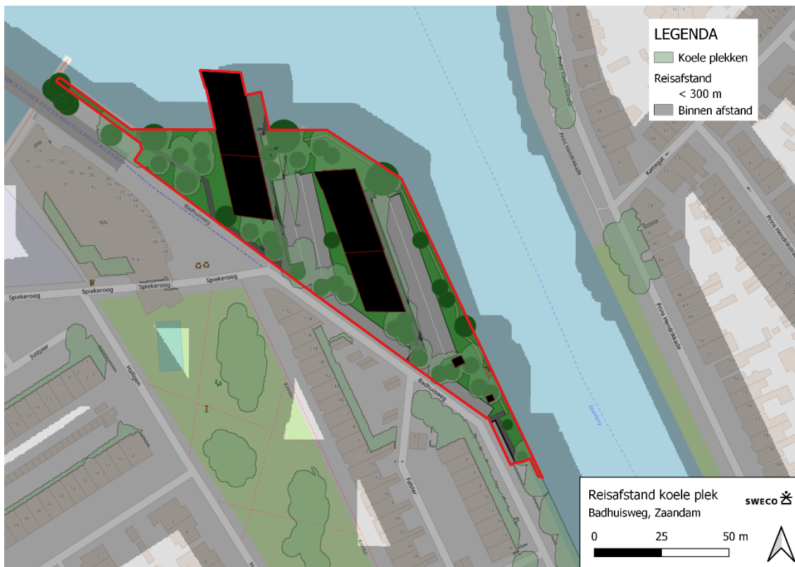
Figuur 11: Aanwezige koele plekken in het plangebied, gegeven de schaduwkaart in figuur 10.
