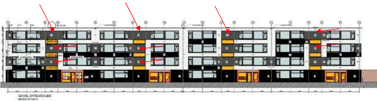
Positie van de kasten aan de gevel van Blok 10, elke pijl is 2 inmetsele kasten
