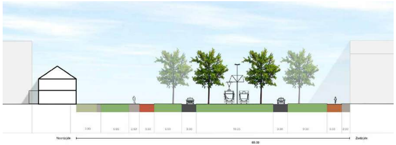
Huidige profiel Burgemeester Roellstraat met achterkanten van de woningen in de Deyssebuurt en zeer brede grasbermen
